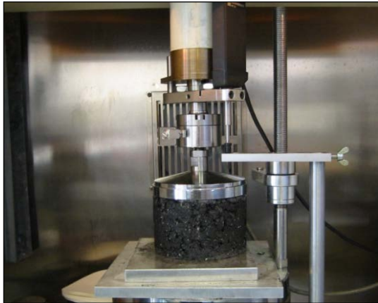
Abbildung 2: Versuchsaufbau des einaxialen Druck-Schwellversuches
